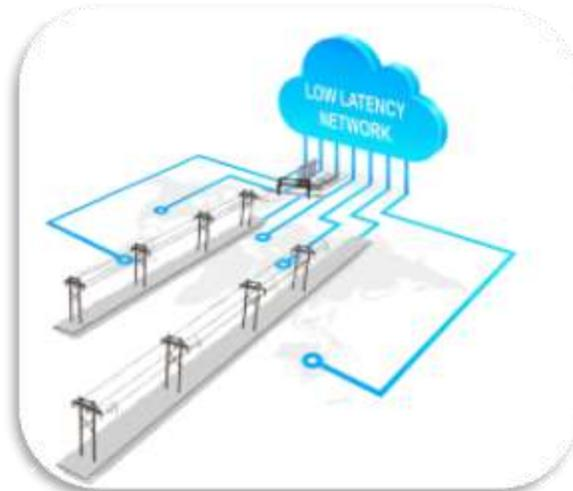
**Comunicación Always-on** con baja latencia entre los nodos de la red y el Sistema Central: restablecimiento de los tramos sanos de la línea **en menos de 1s**
